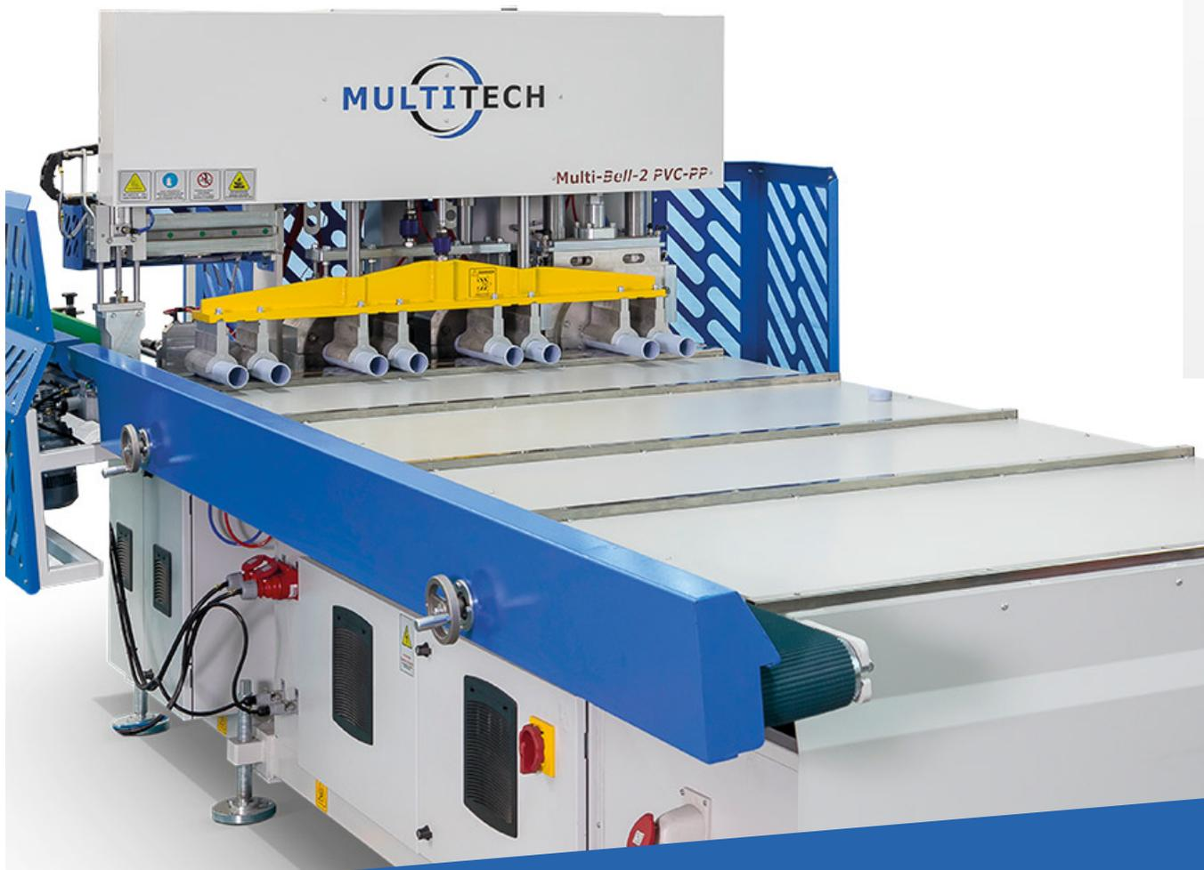
Наши устройства предназначены для раструбки труб для сточных вод, электрических труб и т.д. (ПП-ПВХ-ПЭ) Длина труб: 150 мм – 6000 мм, диаметр раструбов: Ø32 – Ø500 мм. Конструкция раструбочных машин соответствует международным стандартам благодаря использованию системы надува или расширения сердечника. Все электрические и пневматические системы соответствуют стандартам СЕ. Устройства представлены в трех различных моделях, подходящих под разные производственные мощности.
